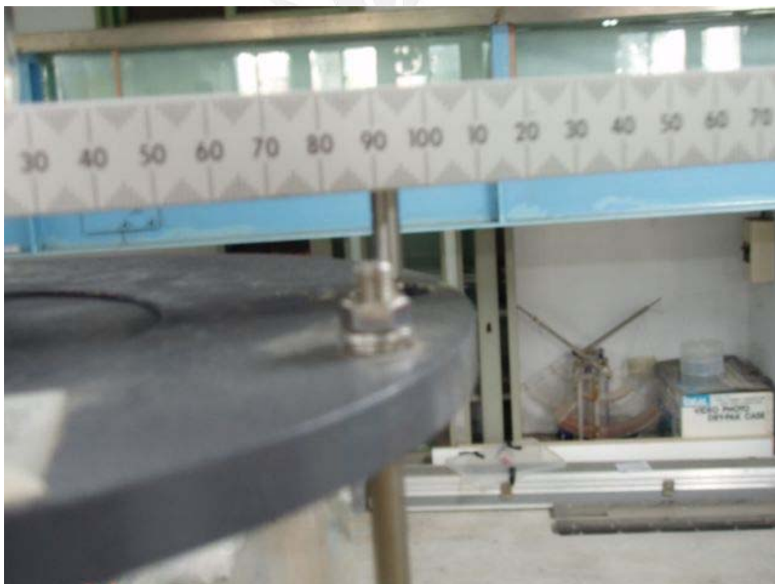
圖十. 想知道桿臂有沒有水平，要看圖中間的標識。
