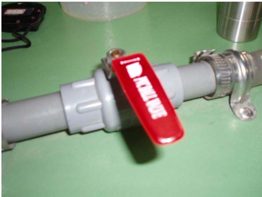
圖七. 控制水量大小的閥門。
