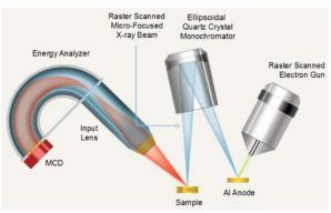
圖 1.6 PHI 5000 VersaProbe at RCAS 儀器裝置示意圖
