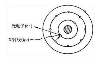
圖 1.4 光電效應原理示意圖
