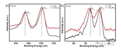
這個是 Pt(鉑)跟 Pd(鈀)形成合金後它表面電子結構的變化,從圖中可以看出,形成 Pt<sub>1</sub>Pd<sub>3</sub>之後,Pd3d 向低場偏移,Pt4f 向高場偏移,說明 Pd 得到電子,Pt 失去電子,也就是說形成合金後,Pt 上的電子部分轉移給 Pd。PtPd 的這種電子轉移也是其形成合金的一個證據。
