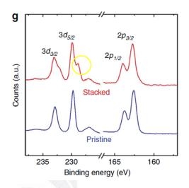
2. 在 MoS<sub>2</sub> 單分子膜上生長超薄膜的聚吡咯作為高性能超級電容器電極[8]。 XPS 提供了 Li 發生相變的證據。對比 MoS<sub>2</sub> 體材料,嵌鋰單層以及複合聚吡咯樣品中 Mo 元素 3d 軌道電子態變化隨複合而發生的相轉變。存在峰位的化學偏移,證明鋰離子的嵌入。
