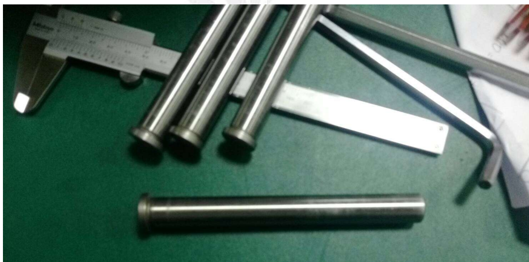
待修正零件圖 2 136.5mm→135mm
