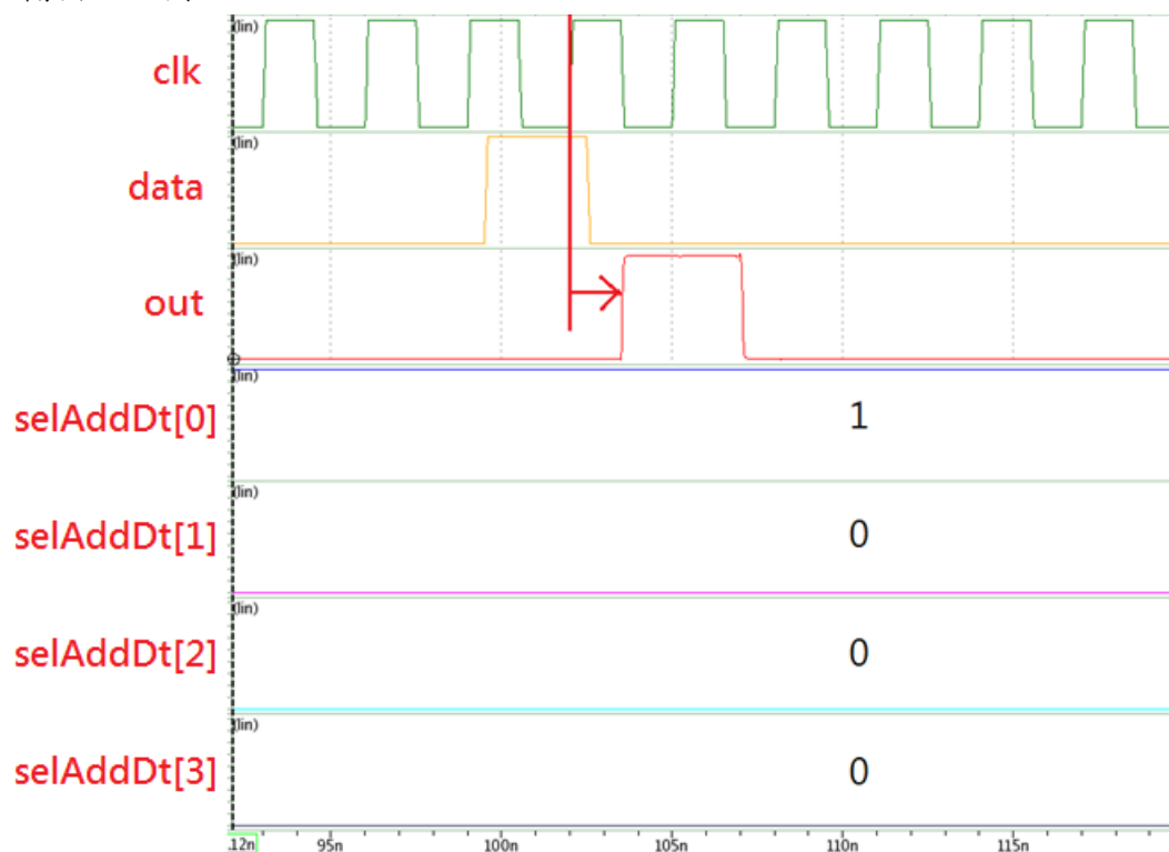
圖 2.7 selAddDt=0001， T_{delay} = (1-1)T_{clk} + T_{and} + T_{or}
