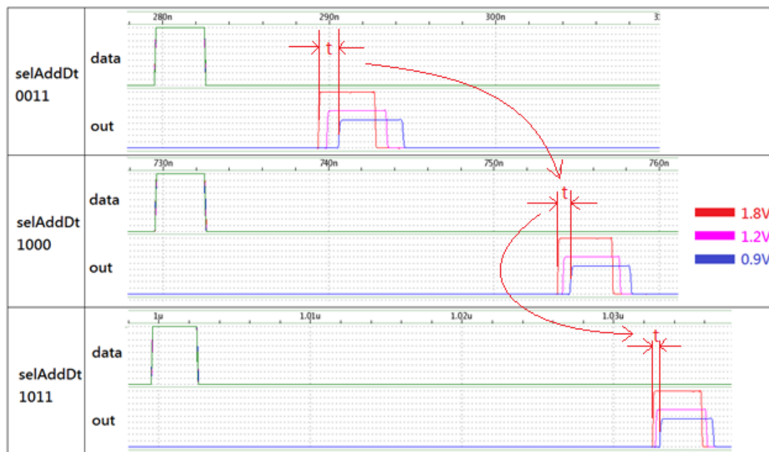
圖 2.11 在 selAddDt 不同時，1.8v 與 1.2v 以及 0.9v 運算時間的差異
