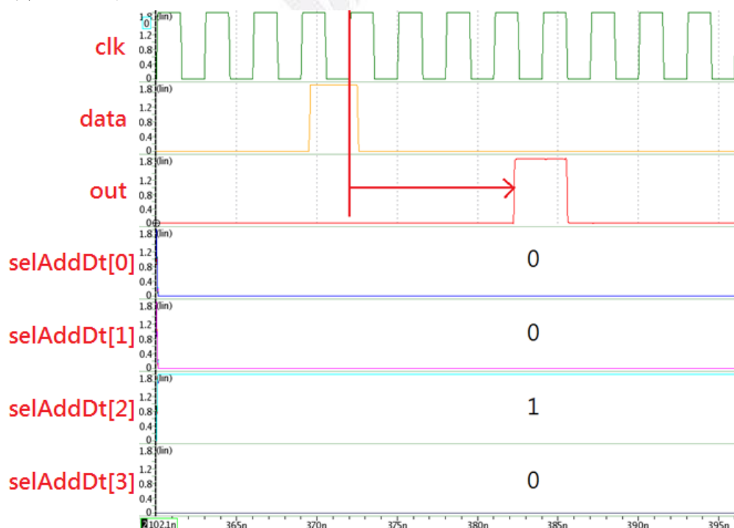
圖 2.8 selAddDt=0100， T_{delay} = (4-1) * T_{clk} + T_{and} + T_{or}
