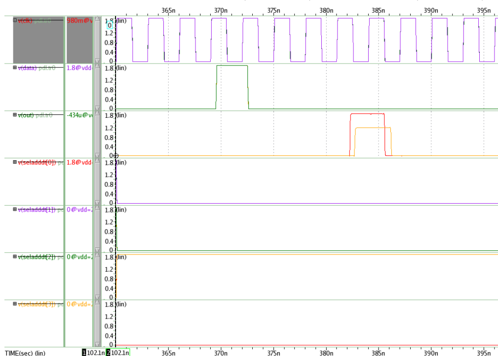
圖 2.9 在 selAddDt=0100 時，相同時間輸入，1.8v 與 1.2v 輸出時間的差異
