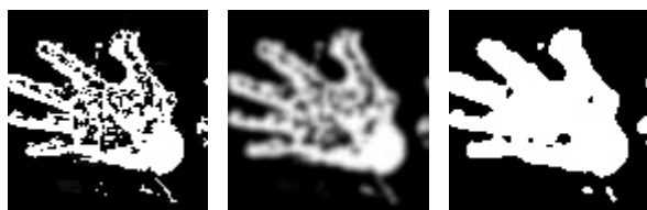
圖 3-1 由左至右分別為原始色彩概率分佈圖、使用高斯金字塔模糊化、將灰度值二元化的結果
