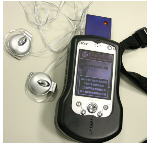
(a)感應式導覽設備外觀 (PDA 加裝 RFID 讀取器與耳機)
