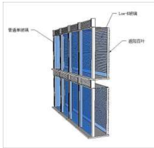
圖 7 雙層玻璃牆示意圖
