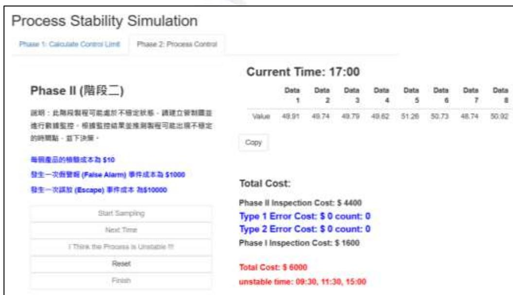
圖 4.15、樣本數為 8 之  $\bar{X}-R$  管制圖結果分析
