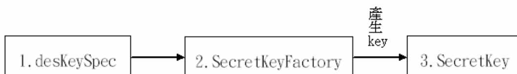
圖 4.3 key 的產生流程
