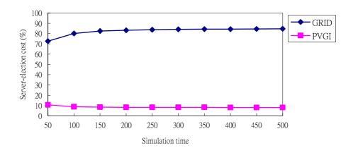
圖 12. Server 選舉成本比較圖 (節點數 100,速度 10~15m/s)
