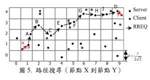
我們以圖 6 來說明: D 先將目的端 Y 的 host ID 附加在 RREP 後,才傳送給 I。當 I 收到 RREP 時,假設找到 I9 當作繞送路徑的中間節點,則將 I9 的 host ID 附加在 RREP 後,再往前送到 H,同時 I 也將收到的 RREP 裡的 host ID 告知 I9。當 RREP 傳到 E 時,因為 E 所在的區域裡並沒有 E client,故 E 將自己的 host ID 附加在 E 化再往前傳。最後 E 不是 E
