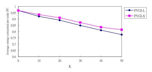
圖 10. k 值與節點平均電量消耗功率的關係 (節點數 100,速度 10~15m/s,模擬時間 500s)
