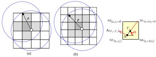
圖 1. Grid 邊長與相鄰 grid 的關係(a)  $d = \frac{r}{\sqrt{5}}$ , (b)  $d = \frac{r}{2\sqrt{2}}$
