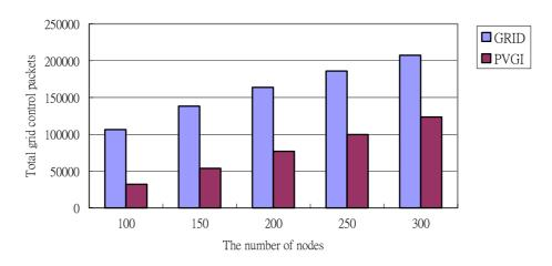
圖 11. Grid 維護之控制封包總數與節點個數的關係 (節點數 100,速度 10~15m/s,模擬時間 500s)
