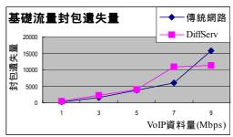
圖 3.10、實驗五基礎流量之封包遺失量
