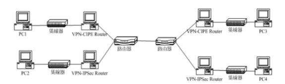
圖 7. 兩種 VPN Tunnel 實作測試環境
